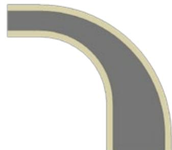
La curva simétrica es aquella curva donde las dimensiones de entrada y de salida, son las mismas, a diferencia de la curva asimétrica donde las dimensiones de entrada y de salida no son iguales.
