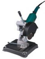
Flexible para cortar los perfiles, con cuchilla de aluminio, mejor si se usa sobre una mesa con prensa para bloquear los perfiles que se están trabajando; no recomendamos sierras de calar o sierras de cinta porque los dientes de corte tienden a atascarse, doblando el perfil en el punto donde comienza a marcarse.
