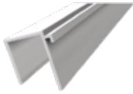
Cuando el ducto está ensamblado proceder con el corte de los perfiles teniendo la prudencia de realizar el corte longitudinalmente de la misma dimensión a los lados internos del conducto, **menos 4 mm di longitud**; esta solución permite de compensar el espesor de los perfiles en el interno del conducto en la fase de ensamblaje.
