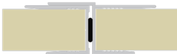
Sistema di connessione a profili in alluminio.
