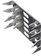
Aplicar las conexiones laterales dentadas, una en cada cara del conducto a unir, colocándolo a mitad de cada lado, en traslape a la línea de unión (aquella siliconada), evitando de doblarlo o pandearlo. Al insertar los dientes sobre la superficie de la lámina se puede recurrir a la ayuda de un martillo con la cabeza de caucho.
