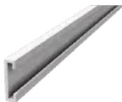
Proceder con el corte de los perfiles a bayoneta teniendo la prudencia de realizar aquellos que en posición final serán verticales, largos cuanto el lado externo del conducto, mientras que las horizontales serán cortadas de longitud iguales al lado externo del conducto más 8 mm.
