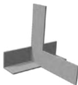
Colocar un angular, bloquearlo con un extremo del perfil que se debe pegar, colocar un segundo angular en el extremo opuesto del perfil e insertar el perfil en la lámina ayudándose eventualmente con golpes ligeros dados con el martillo con cabeza de caucho.
