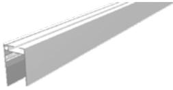
Cuando el ducto está ensamblado proceder con el corte de los perfiles teniendo la prudencia de realizar el corte longitudinalmente de la misma dimensión a los lados internos del conducto, **menos 3 mm de longitud**; esta solución permite de compensar el espesor de los perfiles en el interno del conducto en la fase de ensamblaje.
