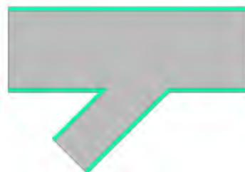
Las desviaciones estáticas se pueden unir al conducto principal con una conexión usando pegamento y cinta adhesiva. Esta conexión es llamada Macho/Hembra para extensiones cortas y livianas, o pueden estar hechas con perfiles, cuando se unen porciones de ductos más grandes, largas o con accesorios pesados (ej. difusores, rejillas o válvulas de control).
