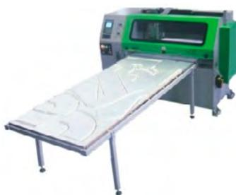
Cortadora automática: logra la optimización del corte de las láminas Isocanale y el corte de las mismas en tiempos muy reducidos. Toda la fase de diseño y corte viene administrada desde el terminal de un PC, con el único esfuerzo el de cargar la lámina en la máquina.
